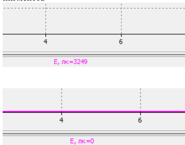
Рис. 17. Показания датчика освещенности возле герани на свету – 3249 Лк (сверху), и в темноте (фото снизу)
